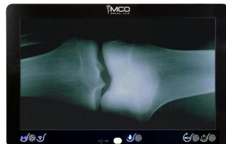
Alle **neuen Produkte** präsentieren sich in einem einheitlichen und modernen Design in den Größen **21.5"**, **24"** und **27"** und wurden für den Einsatz in kritischen klinischen Umgebungen entwickelt und erfüllen die Anforderungen der **EN 60601-1**. Neueste Touch-Technologien, optionales optisches Bonding, erweitertes ECO-Management und kapazitive Funktionstasten sind nur einige wenige der vielen Innovationen dieser neuen Produktgeneration.
